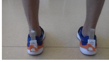
Yayak tabanına yerleştirilen elektortların bulutut ile veri alımına hazır hale getirilmesi.
